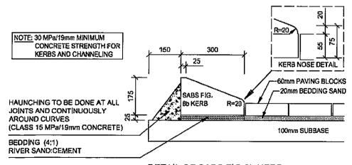
DETAIL OF SABS FIG 8b KERB FOR NEW CONSTRUCTION
